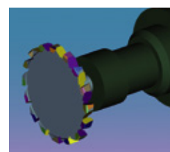
千鳥刃サイドカッター Staggered tooth side milling cutter
